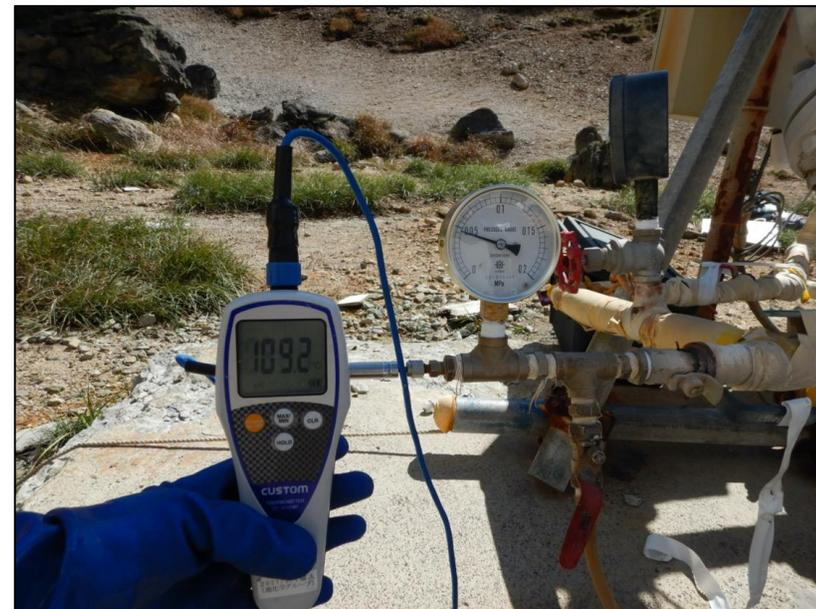
蒸気モニタリング(坑口の温度測定)
