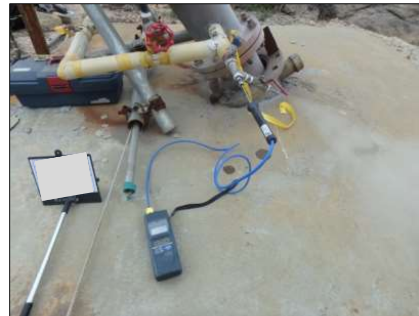
蒸気モニタリング(坑口の温度測定)
