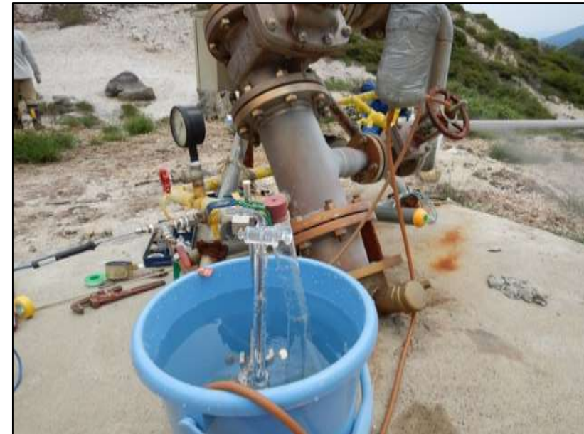
蒸気モニタリング(温泉井の蒸気採取)
