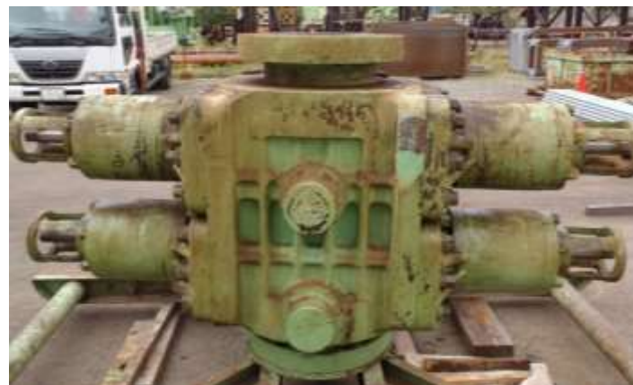
暴噴防止装置 (掘削中の蒸気の噴出を防ぐ)
