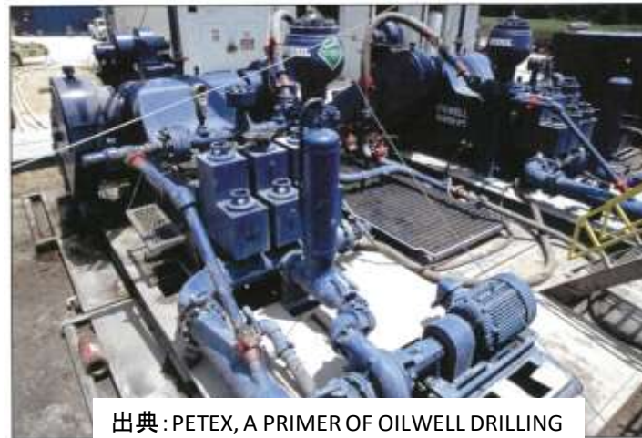
泥水ポンプ (掘管の中に泥水を送り込む)
