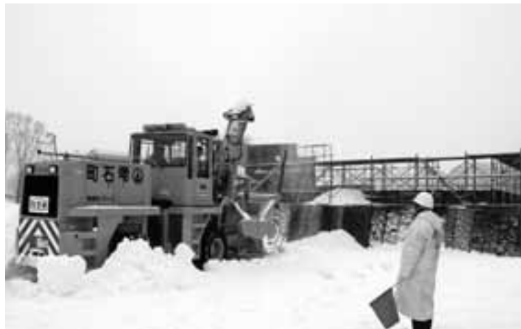
雪像の型枠に雪を吹き込むロータリー車
