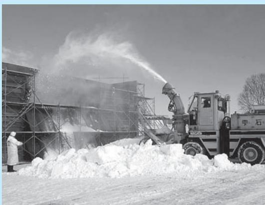
雪像の型枠に雪を吹き込むロータリー車
