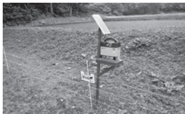
有害鳥獣被害防止に有効な電気柵
