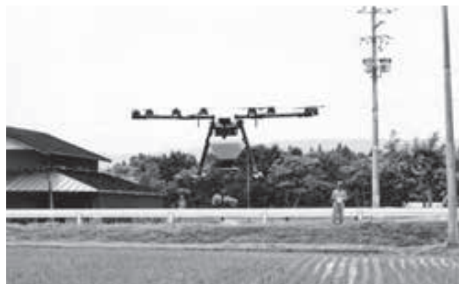
除草剤を散布するドローン
