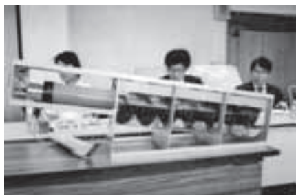
3 cm の水位で発電できる 「らせん式ピコ水力発電装置」
